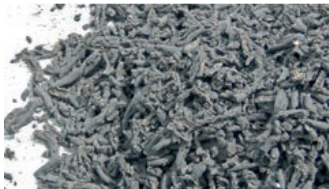
Obr. 1: Vysušený kal ve formě pelet
