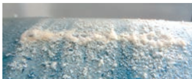
Ukázka „zahojení“ poškození povrchu na trubce NATURAL® pomocí zinkových solí
