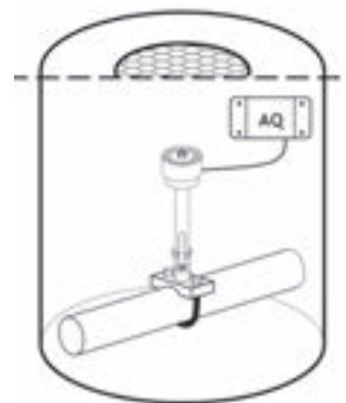
Obr. 9: Aqualink flow sensor – schéma osazení
