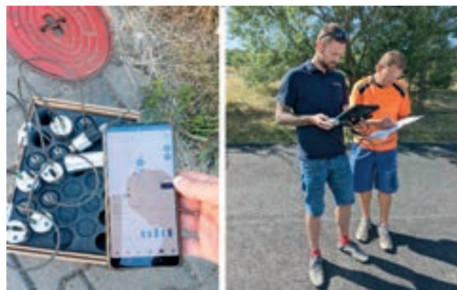
Programování a osazení snímačů za pomoci tabletu či chytrého telefonu s danými aplikacemi
