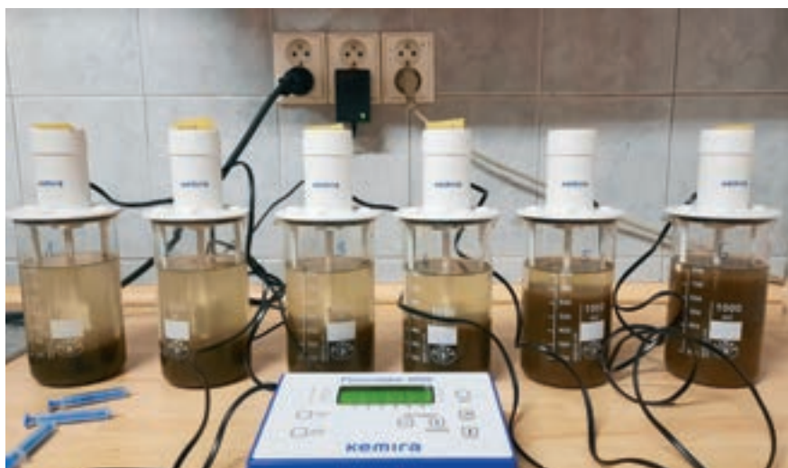
Obr. 4: Testování sedimentace při různých poměrech primárního a terciárního kalu
