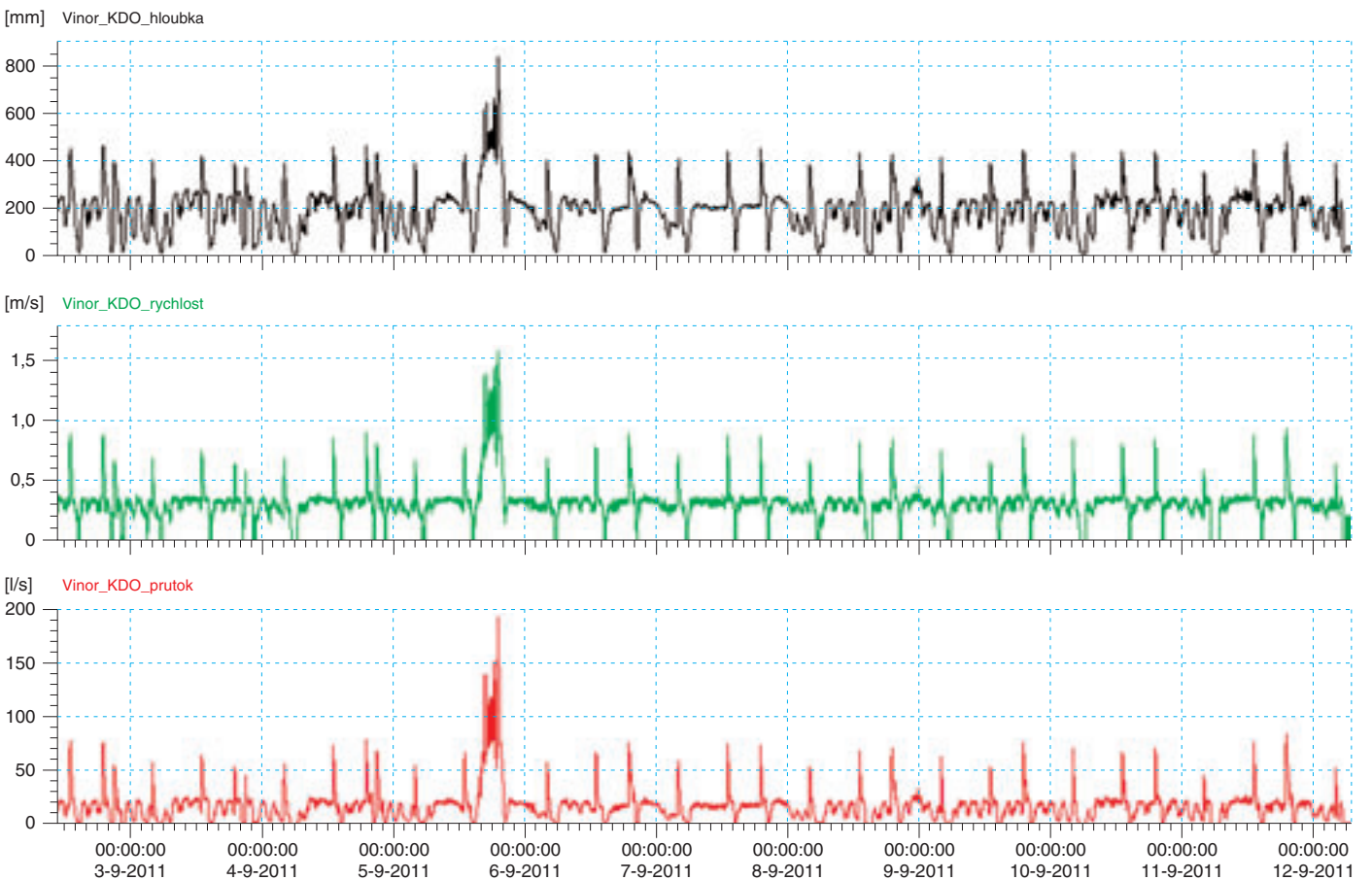
Graf 7: Surová naměřená data z průtokoměru M4016-KDO instalovaného na odtoku ČOV Vinor
