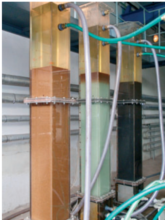
Obr. 1: Modelové filtry na ÚV Bedřichov (v popředí písek, uprostřed skleněné kuličky, vzadu Filtralite Mono-Multi)
