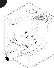
Vírový ventil v suché šachtě FluidCon
