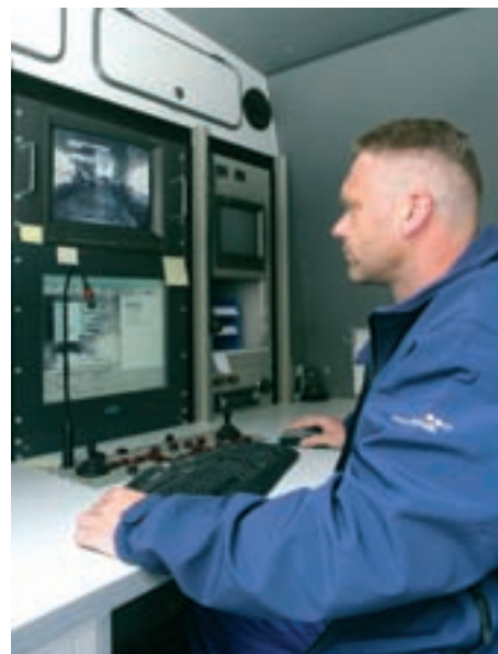
Foto 3: Při kamerovém monitoringu stavu kanalizační sítě na prachatickém sídlišti narazila kamera na tradiční problém – zanesení kanalizace tuky, které znemožnily průjezd kamerou. Natáčení mohlo pokračovat až po jejich mechanickém uvolnění přivolaným specialistou.
