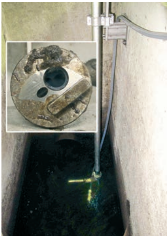
Obr. 1: Zákaloměrná sonda včetně sací hadice vzorkovače v měrném profilu. Ve výřezu sonda po vyjmutí z měrného profilu (po 3 měsících)
