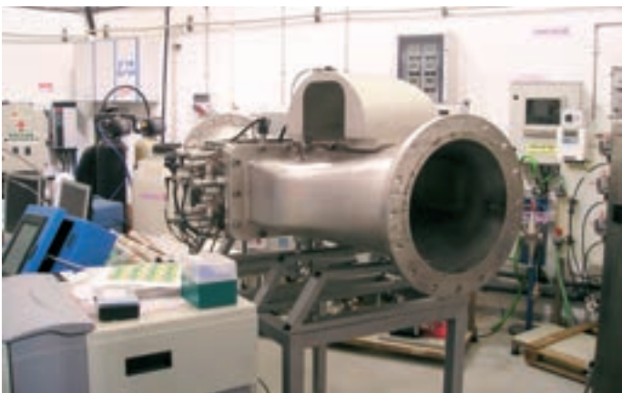
Obr. 3: Ukázka mohutné jednotky pro dezinfekci vody s využitím UV – záření a vhodné hydrodynamiky procházející vody
