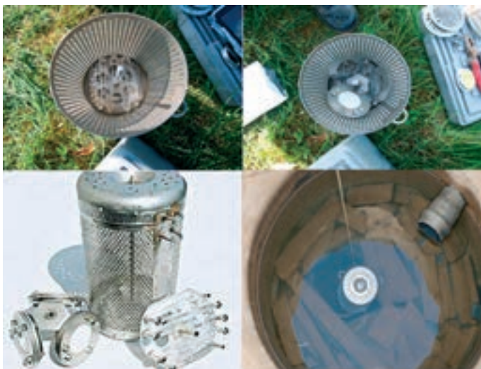
Obr. 4: Pasivní vzorkovač POCIS a jeho umístění ve vrtu P10 (Onšovice)
