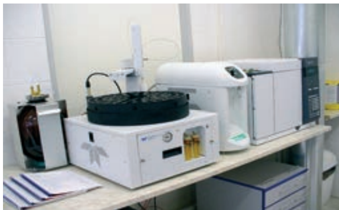
Obr. 2: Plynový chromatograf Agilent Technologies 7890B na stanovení těkavých organických látek ve vodách
