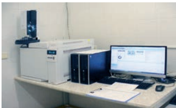
Obr. 3: Plynový chromatograf Agilent Technologies 7820A na stanovení organochlorových pesticidů ve vodách
