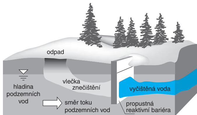
Obr. 2: Schematické znázornění propustné čistící stěny
