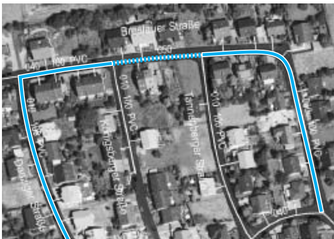
Obr. 6: Plán s vyznačenými rozvodnými řadami s vysokou dynamikou poruch
