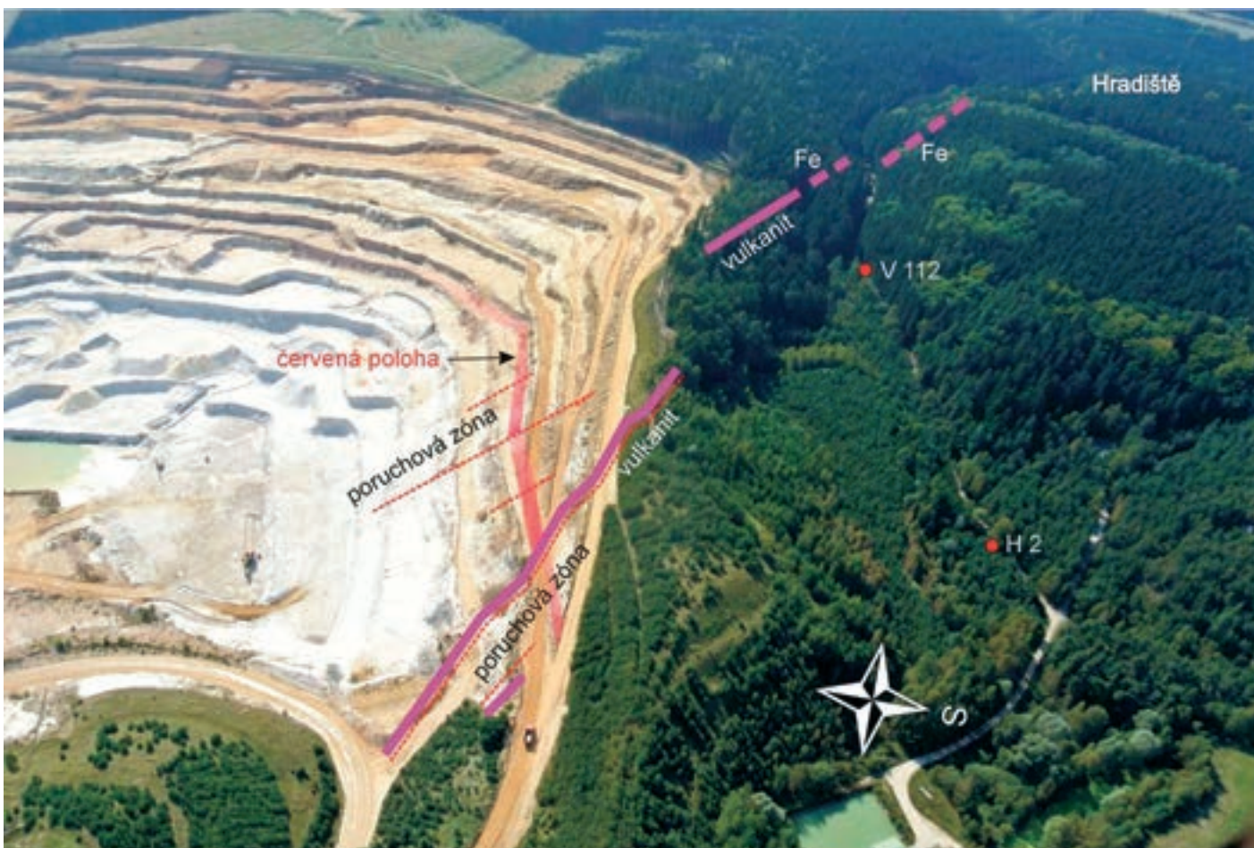
Obr. 10: Letecký snímek s vyznačením průběhu vulkanických žil v lomu Střeleč a v jeho předpolí (foto D. Smutek)
