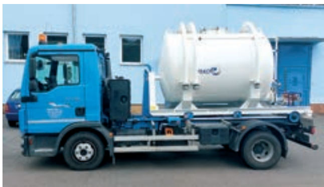
Obr. 3: Pojízdná cisterna, přizpůsobená pro doplňování vápence
