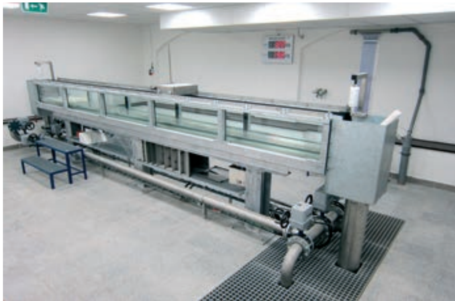
Obr. 1: Hydraulický měrný žlab hydrotechnické laboratoře Stavební školy Vysoké Mýto
