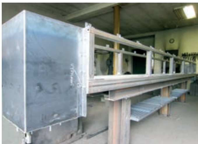
Obr. 3: Pohled na konstrukci měrného žlabu před jeho žárovým zinkováním
