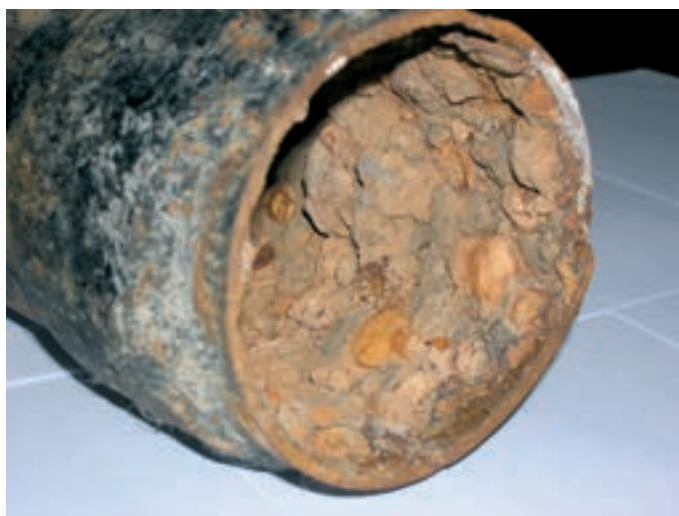
Obr. 6: Potrubí se sníženým průtokovým profilem
