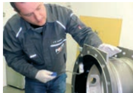
Nanášení keramického nátěru PATIG do vnitřního prostoru uzavírací klapky
