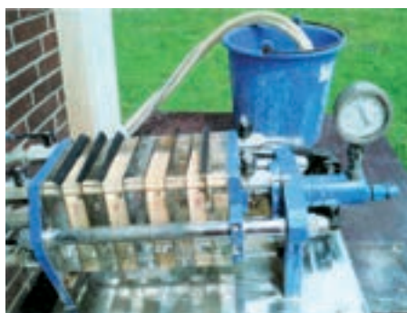
Obr. 3: Rámový kalolis ke stanovení odvodnitelnosti vápenných kalů
