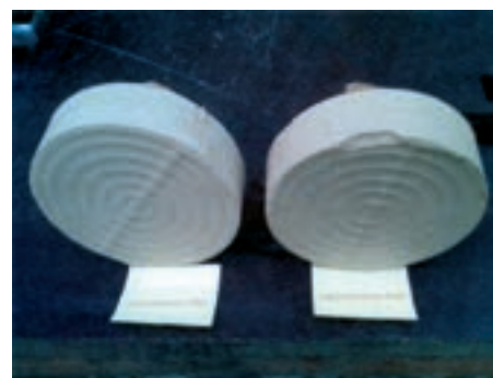
Obr. 4: Vylisovaný vápenný kal, vlevo se syntetickým pomocným koagulantem, vpravo s pomocným koagulantem na bázi škrobu
