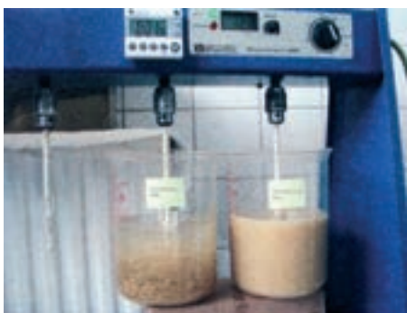
Obr. 2: Srovnávací míchací pokusy se syntetickým (vlevo) a škrobovým pomocným koagulantem (vpravo)
