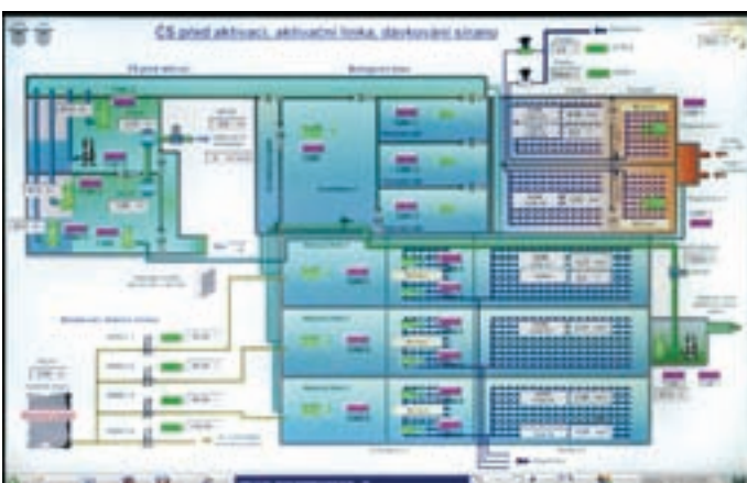
Fotografie obrazovky řídicího systému ČOV – aktivace
