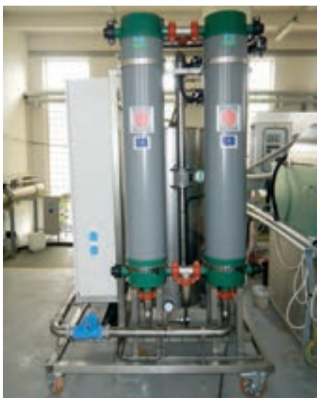
Obr. 1: Pilotní ultrafiltrační jednotka – rám ultrafiltrace: pohled na skříň rozvaděče (nahore) a membránové moduly (dole)
