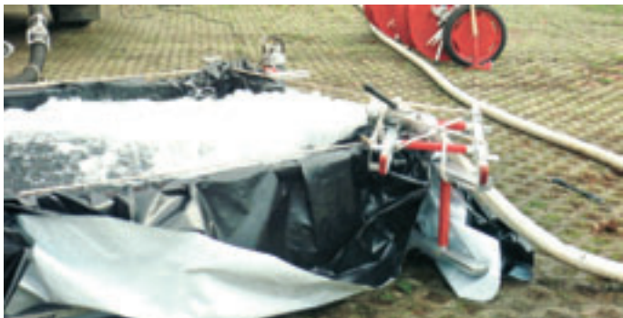
Obr. 3: Možnost zajištění „volného výtoku“ za použití trubkové konstrukce a pružného uvázání při školení protipožární ochrany
