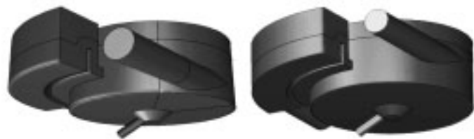
Obr. 2: Tlakový přítok do HDVS (levý obrázek – HDVS1) a přítok s volnou hladinou (pravý obrázek – HDVS2)
