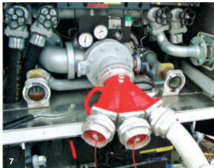
Obr. 5: Hadicová armatura se zpětnou klapkou a zavzdušovačem, upravená pro napojení na hadice
