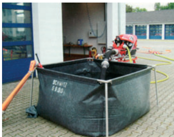
Obr. 1: Při seminářích „Hašení požárů pěnou“ pořádaných LFKS Rheinland-Pfalz je na rozvrhu hodin také ochrana pitné vody. Na obrázku je jednoduše realizovatelný „volný výtok“, zde za použití přerušování přívodu ze sítě skládací nádrží. Na přívodu vody je dodatečně instalován uzavírací ventil nebo rozdělovač.
