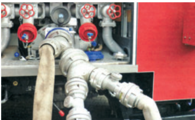
Obr. 4: Paralelní použití armatur se zpětnou klapkou jako možné „nouzové řešení“ pro zlepšení ochrany pitné vody. Navíc jsou zde nutné rozdělovač a spojovací kus. Tento celek je možno také přímo namontovat na cisternový vůz.
