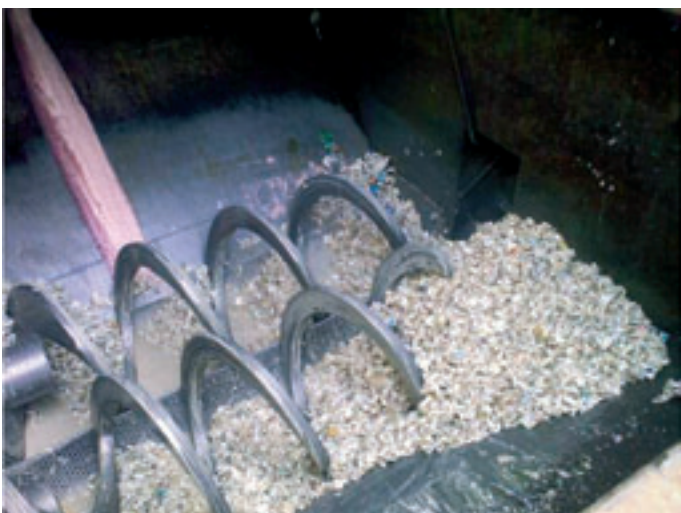
Obr. 12: Separace BRO od obalů
