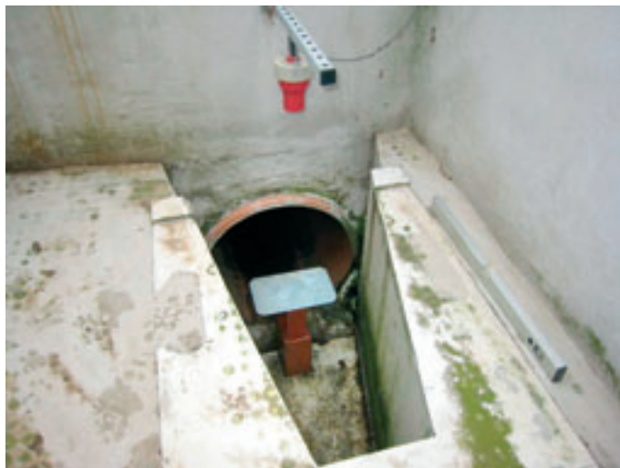
Obr. 5: Simulace hladiny pod ultrazvukovým hladinoměrným snímačem umístěním odrazného povrchu
