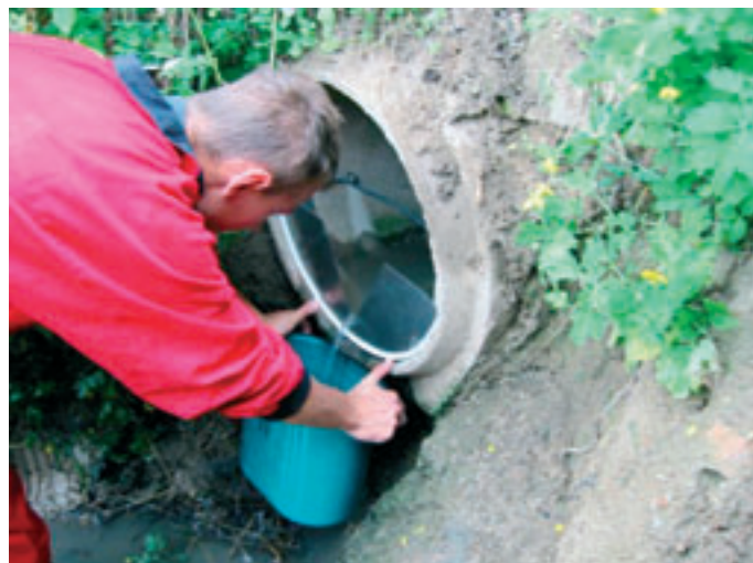
Obr. 8: Aplikace objemové metody za přepadem vody z ostrohranného přelivu
