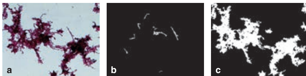
Obr. 6: a) původní plno-barevný (RGB) obraz vloček (zvětšení 500x); b) oddělená vlákna; c) jednotlivé vločky bez vláken
