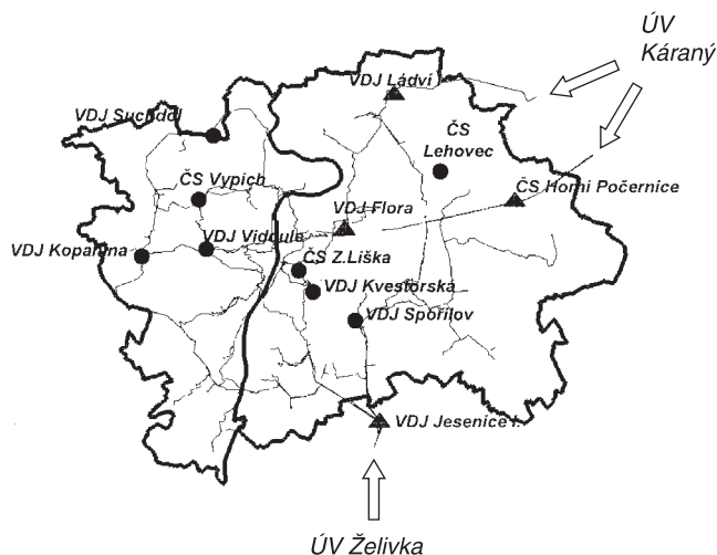
Obr. 1: Vodojemy, navržené pro instalaci dochlorovacího zařízení
