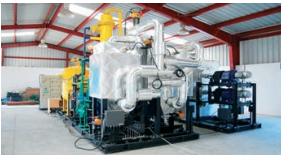
Obr. 3: Pyrolýzní jednotka M3RP (poskytnuto Thersion a. s.)
