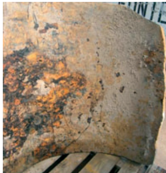
Vzorek č. 2 – půlka seku trubky DN 1100, délka 1 metr
