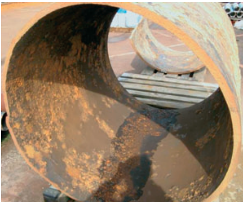
Vzorek č. 1 – sek trubky DN 1100, délka 1,4 metru
