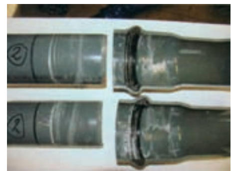
Obr. 3: Hrdlový spoj trub z PVC s nadměrným použitím kluzného prostředku na straně, který je ve styku s pitnou vodou, po 24 hodinách statického máčení
