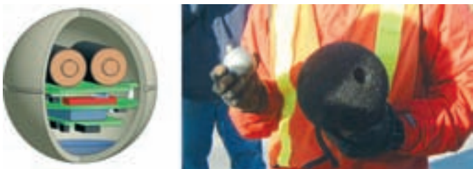
Obr. 1: 2" hliníkové jádro obsahující přístroje balónku SmartBall a vnější molitanový ochranný obal
