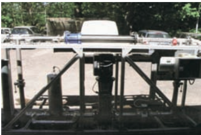
Obr. 1: Speciální poloprovozní výzkumné zařízení se zamontovaným hrdlovým spojem litinové trubky jako zkušební objektem
