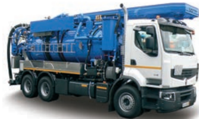
Obr. 4: Kanalizační vozidlo KROLL/HELLMERS
