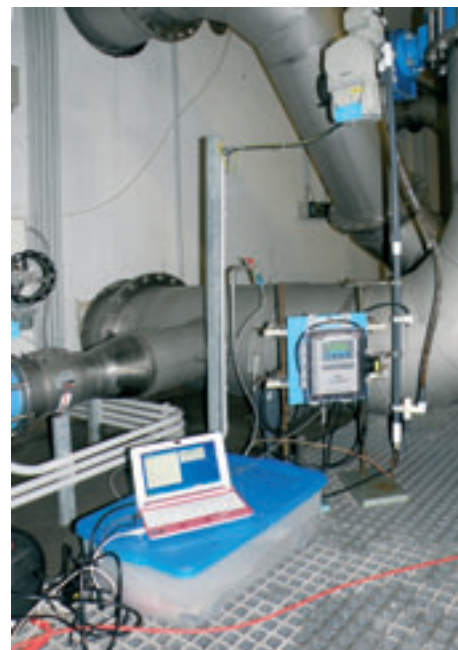
Obr. 2: Počítač částic s notebookem pro ukládání naměřených dat při měření kvality filtrátu na ÚV Souš
