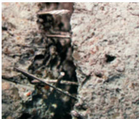
Obr. 1: Trojrozměrné rozdělení vláken ušlechtilé oceli v trhlíně maltové matice zkušebního tělesa po zkoušce pevnosti v tahu při ohybu
