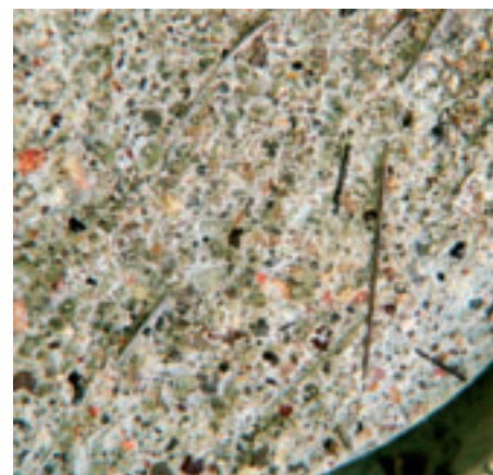
Obr. 5: Provázní nosné vrstvy v rovině lomu při zkoušce pevnosti v tahu při ohybu
