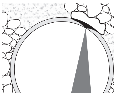
Schéma narušování ostění vlivem proudící vody
