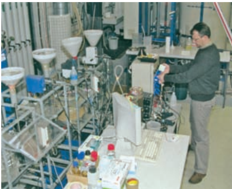
Obr. 1: V tomto uspořádání probíhají za kontrolovaných poměrů stejné procesy jako ve velkých nádržích čistírny. Reaktory umožňují stanovení rychlostí rozkladu léků při čištění odpadních vod.
