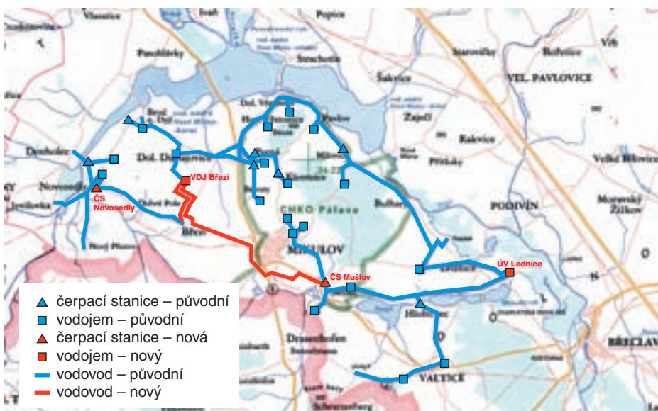
Obr. 2: Schéma skupinového vodovodu Lednice – Mikulov – Novosedly
